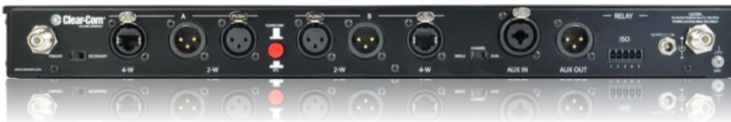
À l'arrière, la connectique est disponible pour 2 réseaux 2 fils, 2 entrées/sorties 4 fils et une entrée/sortie auxiliaire. La connexion 2 fils peut être commutée pour accepter le standard Clear-Com ou RTS, avec fonction auto-nulling permettant une intégration rapide du réseau 2 fils sans echos.
