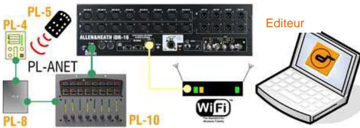
**Opérer sans surface de contrôle** Laissez votre Surface de contrôle au dépôt et pilotez votre rack iLive T en utilisant juste votre ordinateur portable pour un contrôle compact et discret dans certaines situations. Vous pouvez rajouter une ou plusieurs unités PL si vous souhaitez assigner certains contrôles manuels (Canaux les plus importants, DCA et Mix principaux).
