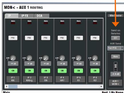
Allumer la page **ROUTING** située sous l'écran tactile pour afficher les assignations et les informations d'aiguillage pour les entrées ou les bus de mixage en cours de sélection via le bouton **SEL** de tranche. Ceci vous donne accès aux options avancées de routing, ainsi qu'à une utilisation alternative de la touche **MIX** lors de l'ajustement des envois et des assignations.
