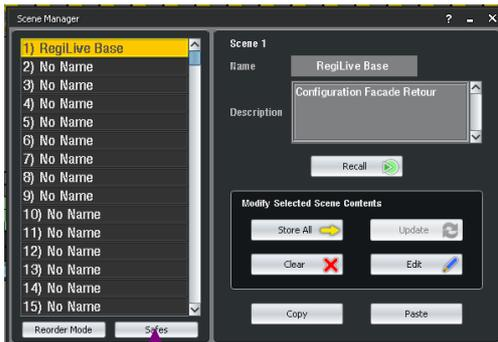
Depuis la version firmware v1.8 une fenêtre « Safe » a été rajoutée permettant de mettre facilement et instantanément en mode Safe uniquement certains paramètres de certaines tranches d'entrées ou bus de sortie, voir de certains DCA ou autres paramètres tel le PatchBay total du système.
