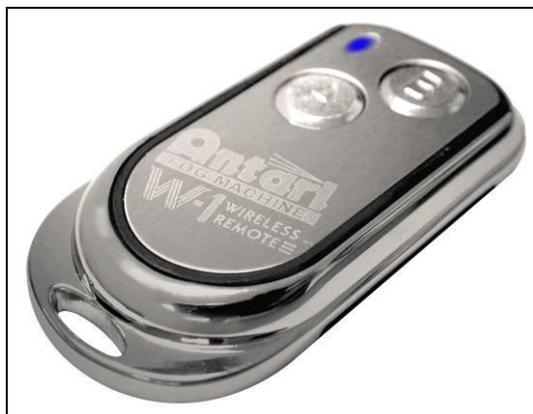
Avec le transmetteur, il est possible de débiter de fumée dedans un rayon d'action de 50 mètres. Le transmetteur est compatible avec chaque récepteur de modèle HZ-350 Hazer et peut contrôler des machines illimitée en mémé temps. Pour dégager la fumée, appuyez sur la bouton "A". Comme contrôle, la LED bleue est allumée. Pour désactiver le débit de fumée, appuyez sur la bouton "B".
