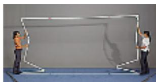
le cadre articulé se déploie d'un seul tenant; les charnières à cliquet sans porte-à-faux sont montées sur des rivets à l'ajustage hyper-précis (brevet STUMPFL); seul une machine peut insérer les rivets dans leur logement. De plus, les articulations sont dans le plan perpendiculaire à la toile. C'est grâce à cela que les cadres ne fléchissent jamais, et sont donc garantis 5 ans
